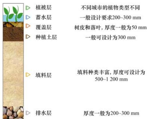
图 1 生物滞留设施结构示意图
