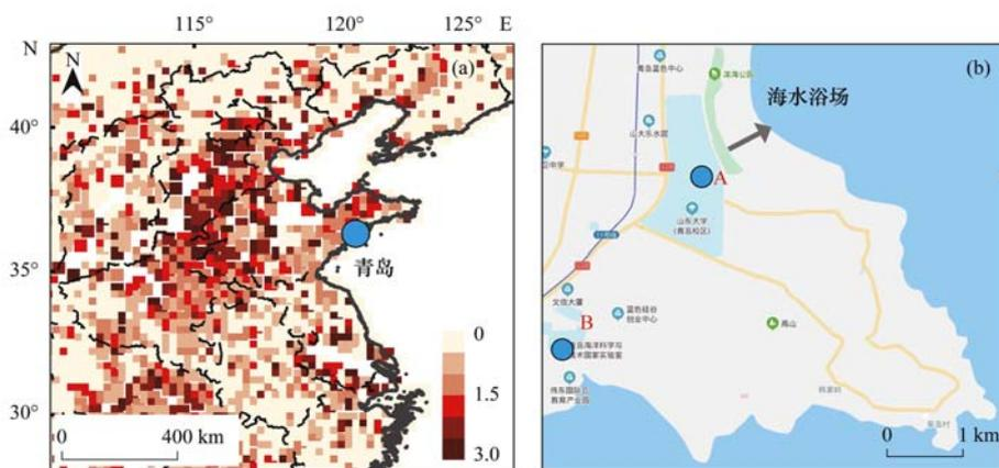
(a) SO<sub>2</sub> 排放量分布, 其中 SO<sub>2</sub> 排放数据源自更新的亚洲排放清单<sup>[28]</sup>, 单位 10<sup>3</sup> t · (a · 网格)<sup>-1</sup>; (b) 观测点地理位置, 源自 <https://map.baidu.com/>, 蓝色圆圈为站点位置: A 点为山东大学青岛校区夏季采样点, B 点为青岛海洋科学与技术试点国家实验室冬季采样点
