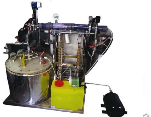
图 1 原位电阻热脱附小试设备
