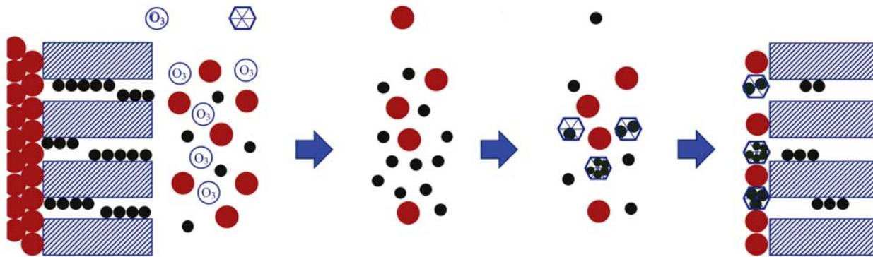
图 17 臭氧-粉末炭预处理控制膜污染的机制
