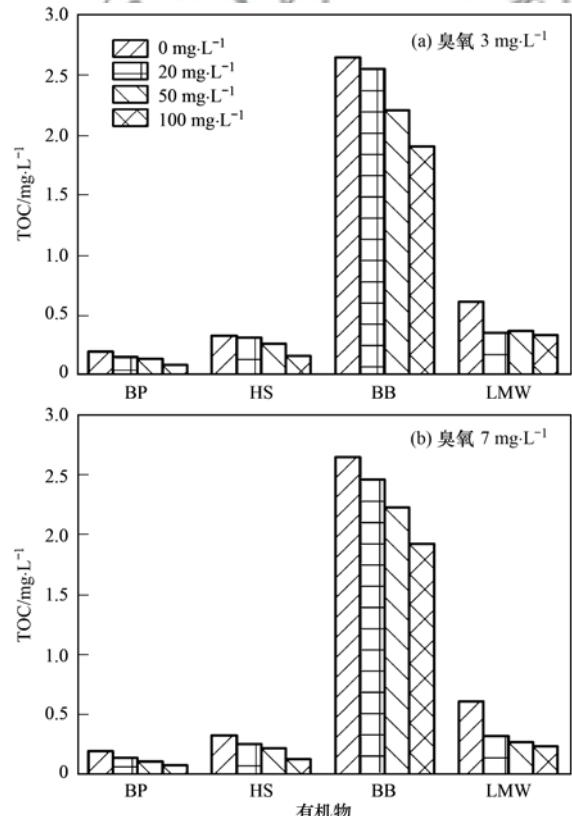
图 11 臭氧-粉末炭联用不同粉末炭投加量下有机物  $M_r$  分布的情况Fig. 11 Distribution of organic  $M_r$  with different PAC-ozone dosages
