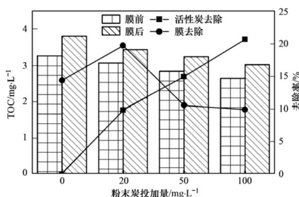
图7 粉末炭投加去除有机物的效果
