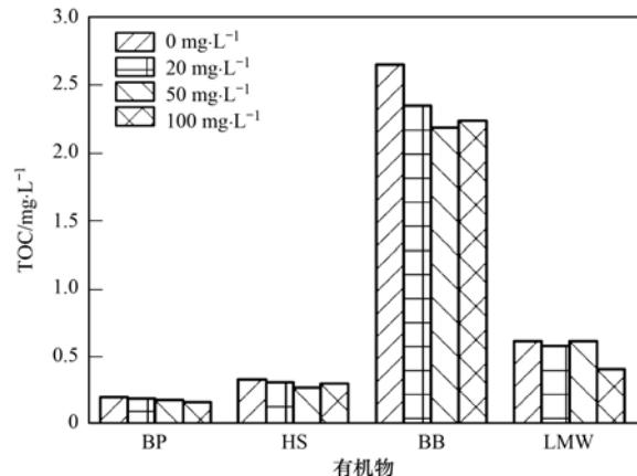
图 10 不同粉末炭投加量下有机物  $M_r$  分布的情况Fig. 10 Distribution of organic  $M_r$  with different PAC dosages
