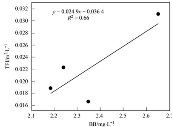
图 16 粉末炭吸附的小  $M_r$  有机物与膜污染的关系
