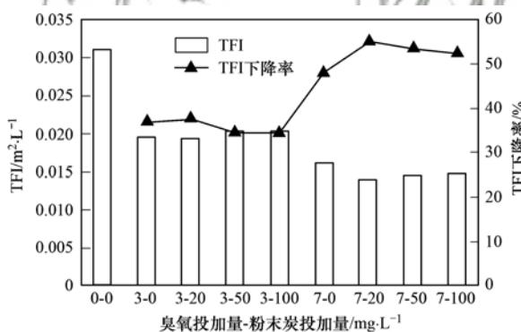
图5 臭氧-粉末炭联用缓解膜污染的效果
