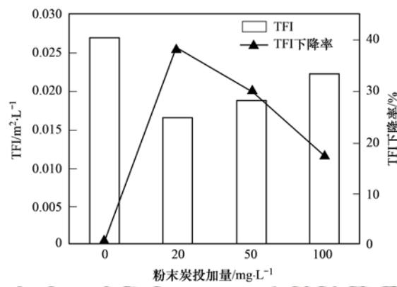
图4 粉末炭缓解膜污染的效果
