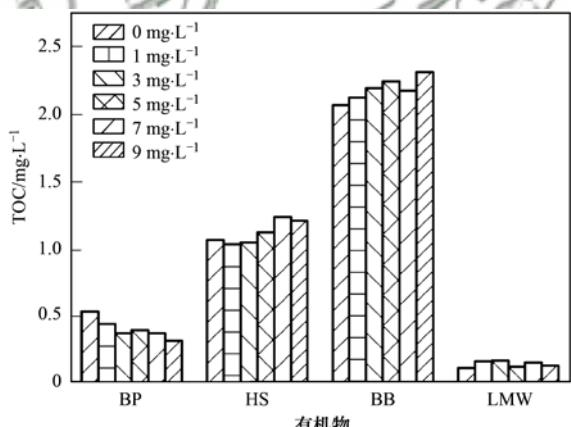
图 9 不同臭氧投加量下有机物  $M_r$  分布的情况Fig. 9 Distribution of organic  $M_r$  with different ozone dosages
