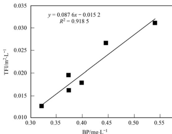
图 15 臭氧氧化的大  $M_r$  有机物与膜污染的关系
