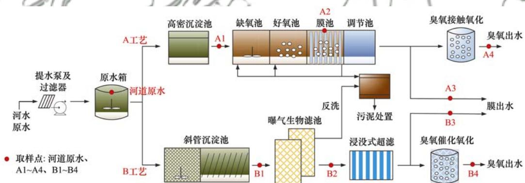
图 1 中试工艺流程及取样点设置示意
