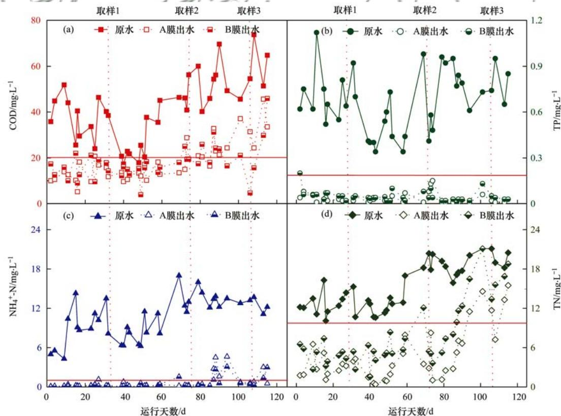
图 2 A、B 两工艺长期运行中的进水及膜出水基础水质
