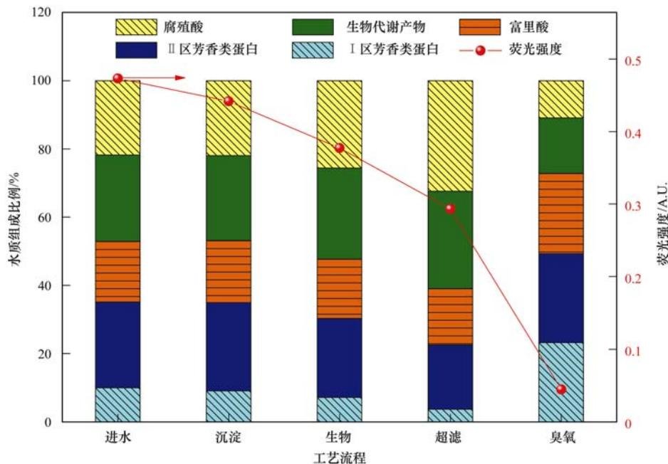
图4 基于三维荧光的各工段水质组成分析
