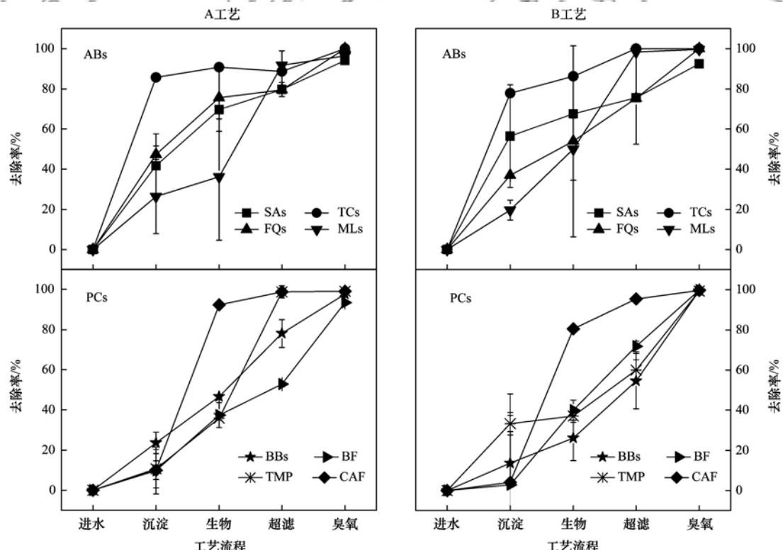
图 3 各类目标 PPCPs 在各工艺流程中的累积去除率
