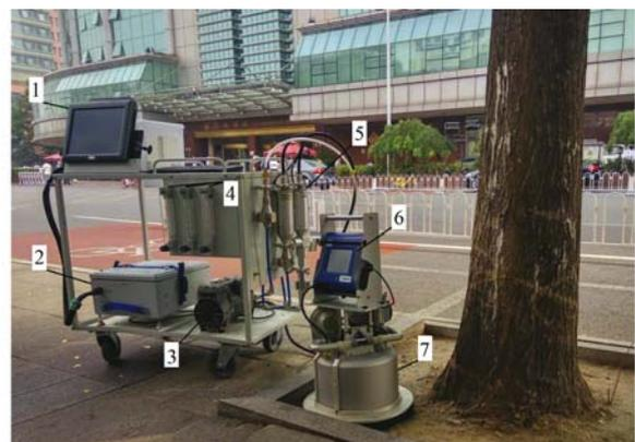
1. 电脑; 2. 控制箱; 3. 真空泵; 4. 流量计; 5. 颗粒物采样器; 6. DustTrak8530 智能粉尘仪; 7. PI-SWERL
