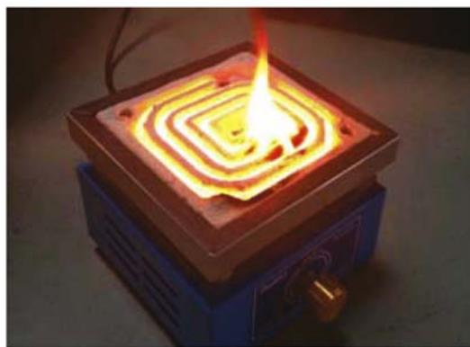
图 2 燃烧煤粉用的电炉
