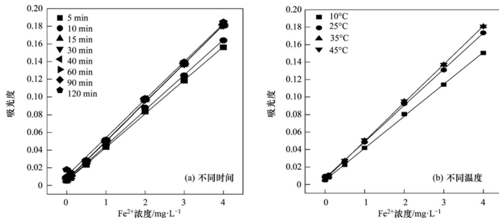
图3 不同时间和温度条件下邻菲啰啉比色法的标准曲线
