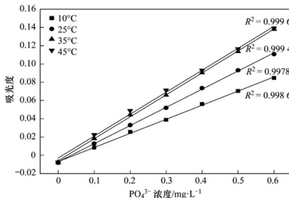
图2 磷钼蓝比色法不同显色温度下的标准曲线
