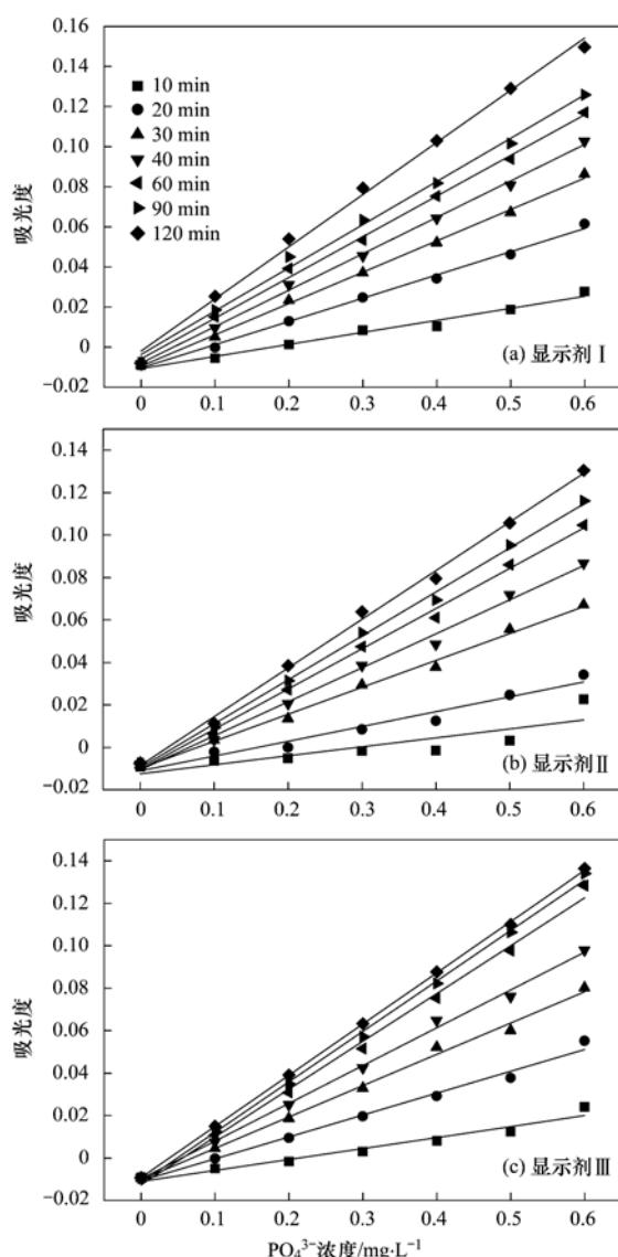
图1 3种磷钼蓝显色剂不同时间下显色的标准曲线
