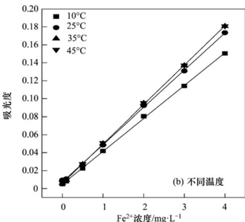
图3 不同时间和温度条件下邻菲啰啉比色法的标准曲线
