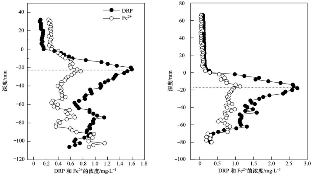
图 4 沉积物间隙水中 DRP 和  $\text{Fe}^{2+}$  的垂向分布
