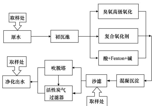
图 4 地下水修复工艺——现场异位高级氧化
