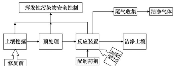
图 3 土壤修复工艺——现场异位土壤蒸汽抽提
