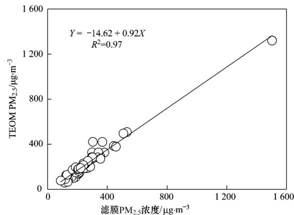
图 1 TEOM-1400a 在线监测与 8 通道滤膜采样 PM<sub>2.5</sub> 质量浓度对比
