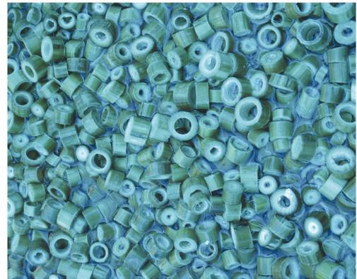
图 2 竹质空心生化球填料实物
