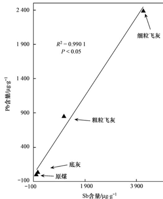
图 4 燃煤产物中 Sb 和 Pb 相关性
