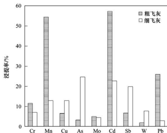
图 2 粗细飞灰中微量元素水溶态浸提率
