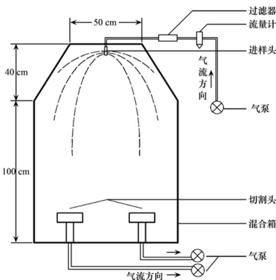
图 1 再悬浮装置结构示意图
