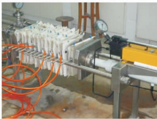
图2 隔膜板框压滤机
