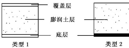
图 1 膨润土结构设计的 2 种类型
