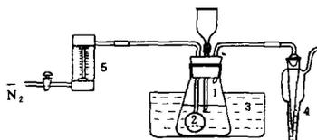
图 1 氮气吹气装置
