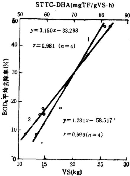
图 4 STTC-DHA、VS 与 BOD<sub>5</sub> 平均去除率的关系
