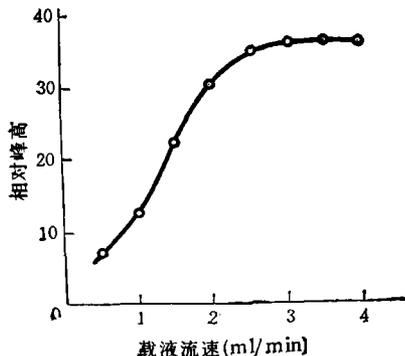
图 3 载液流速对发光强度的影响
