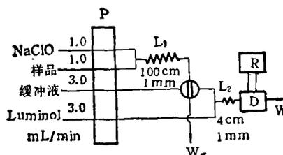
图 1 流动注射化学发光分析系统
