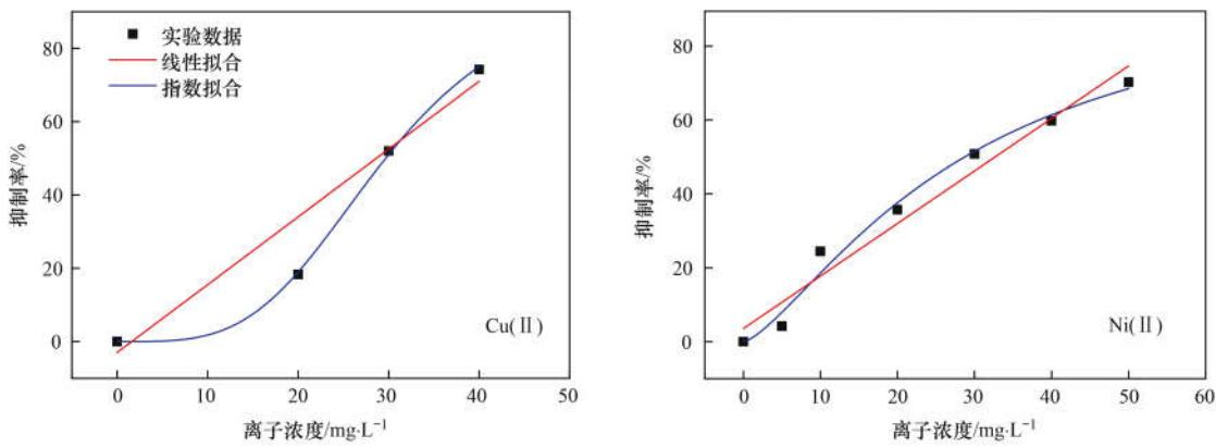
图3 重金属离子抑制 ANAMMOX 的 IC<sub>50</sub> 拟合曲线
