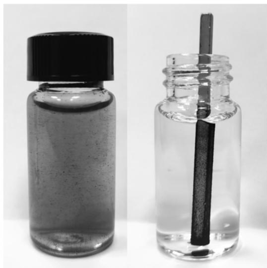
图 1  $\alpha\text{-MnO}_2/\text{MWB}$  的磁性分离
