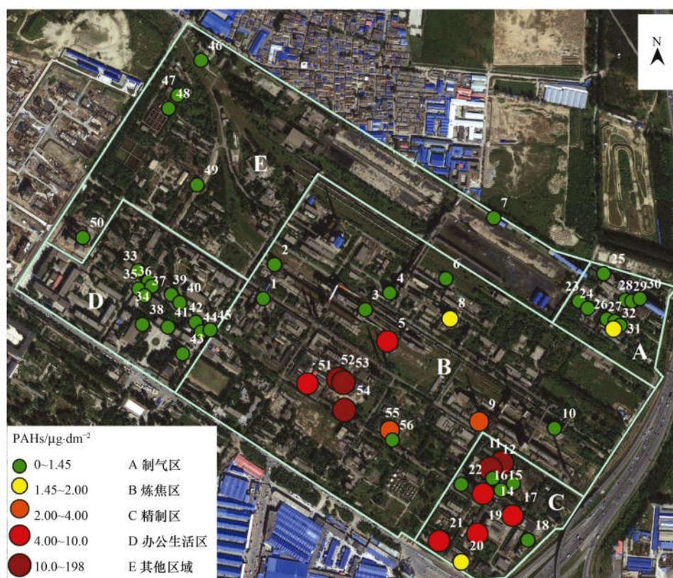
图 1 焦化厂建筑物和生产设施表面 PAHs 含量分布示意
