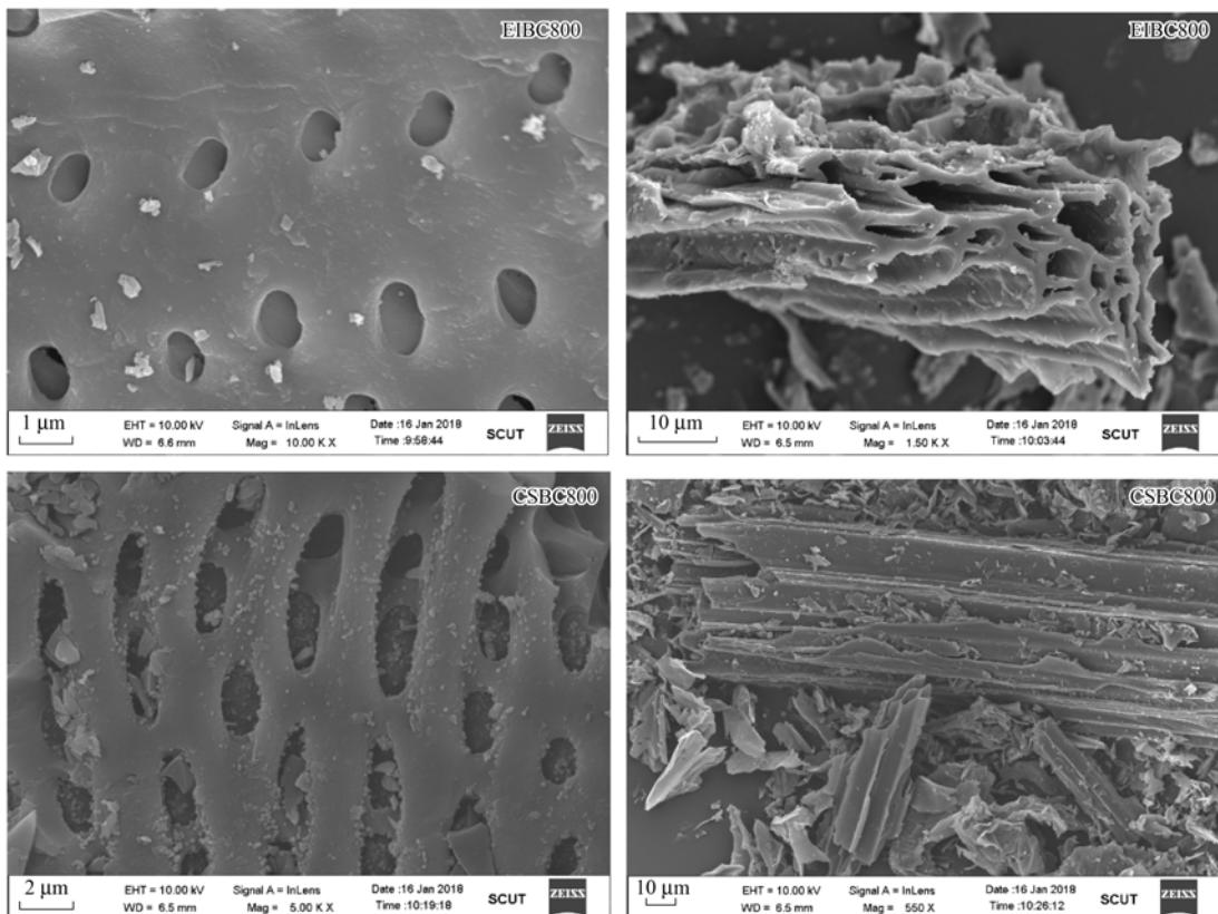
图 1 EIBC800 和 CSBC800 的扫描电镜图
