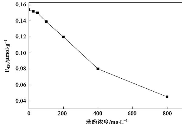
图 3 厌氧颗粒污泥中辅酶 F<sub>420</sub> 随苯酚浓度的变化
