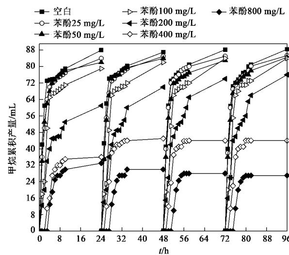
图 1 厌氧颗粒污泥的 SMA 随苯酚浓度的变化
