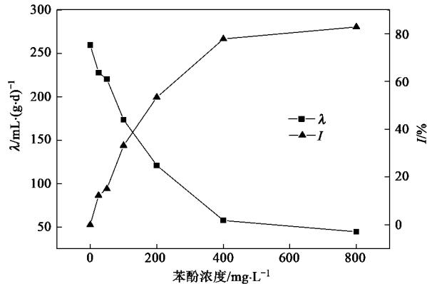
图 2 苯酚对厌氧颗粒污泥 SMA 的影响
