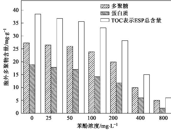
图 4 厌氧颗粒污泥中 ESP 随苯酚浓度的变化
