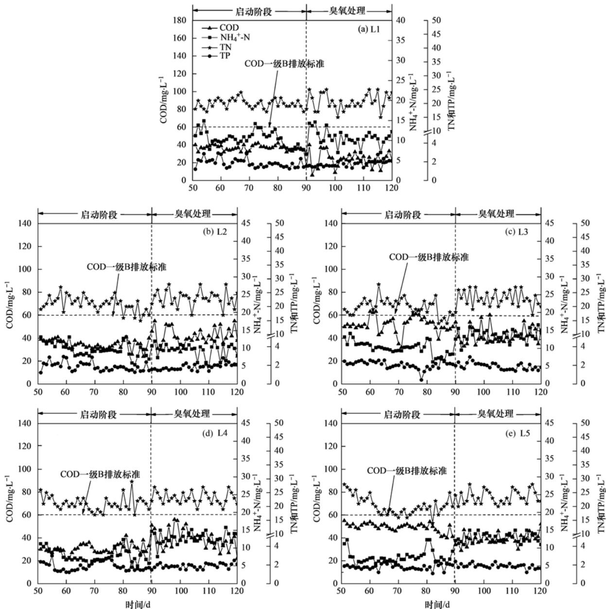
图6 不同污泥龄反应器出水COD、TN、TP和 $\text{NH}_4^+$ -N的浓度变化
