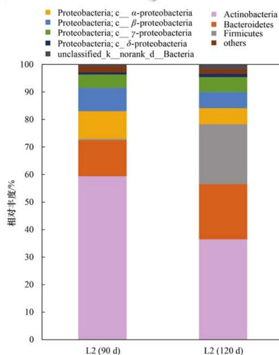
图8 L2 反应器臭氧旁路处理前后污泥微生物菌群结构分布(门水平)
