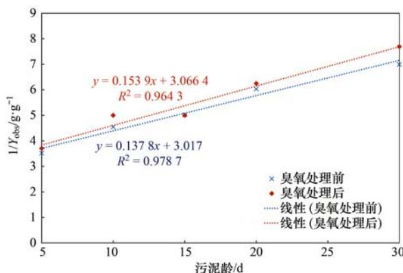
图7  $Y_h$  和  $K_d$  值的图解求定法
