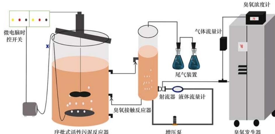
图 1 臭氧原位减量工艺实验装置运行示意
