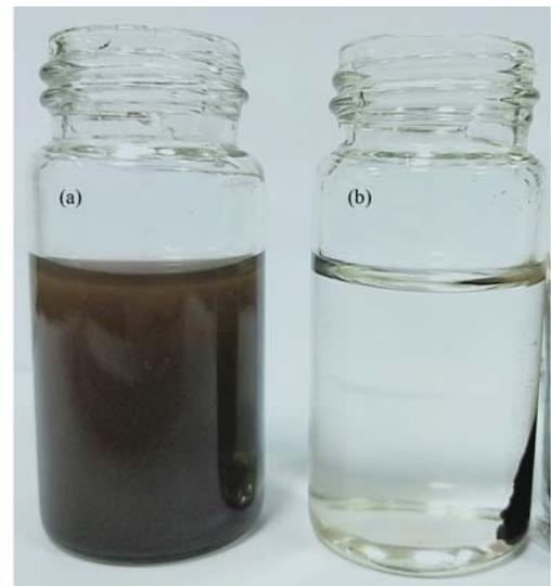
图 1 磁性锆铁改性膨润土的磁分离效果
