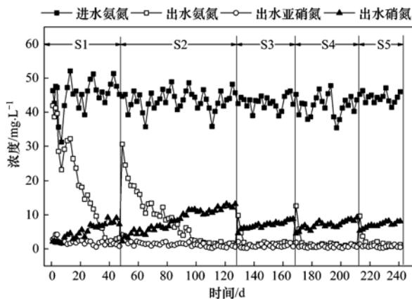
图2 氨氮、亚硝氮和硝氮浓度的变化
