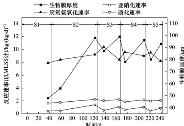
图 6 生物膜厚度及反应速率
