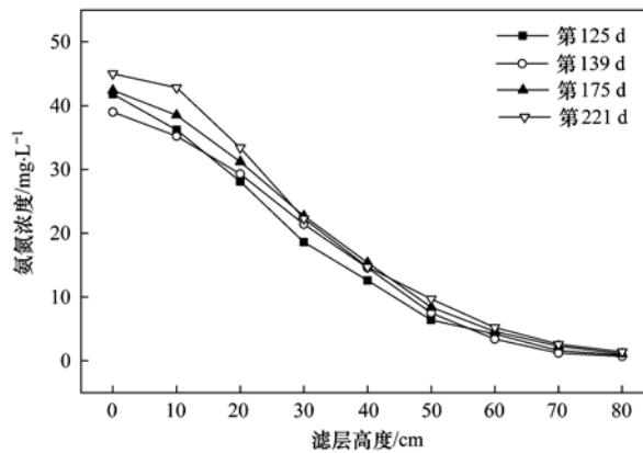
图5 滤柱氨氮沿程变化
