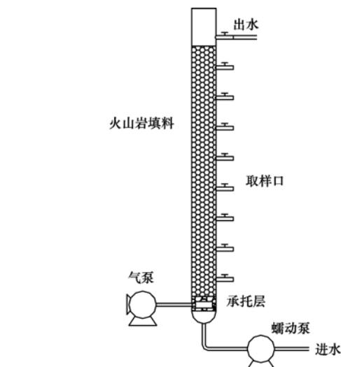
图 1 反应器装置示意
