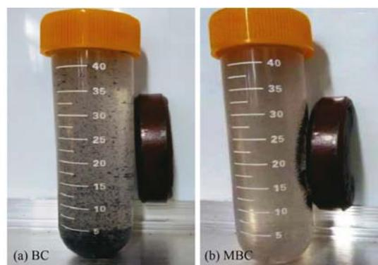
图4 小麦秸秆炭和复合材料在水中的磁化表现
