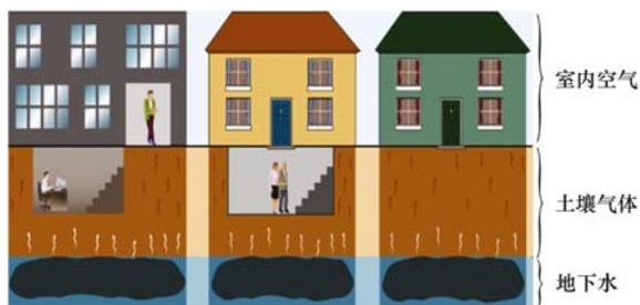
图 2 挥发性污染物室内入侵的示意
