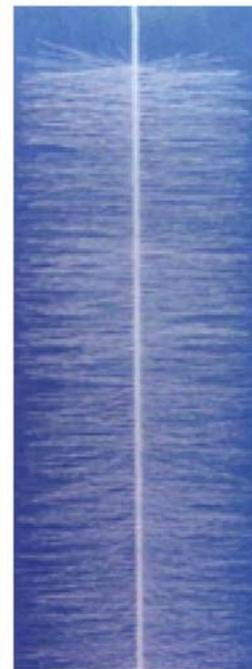
图 2 周丛生物富集载体:工业弹性填料
