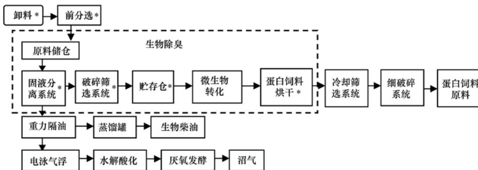
图1 西宁餐厨垃圾厂工艺流程示意
