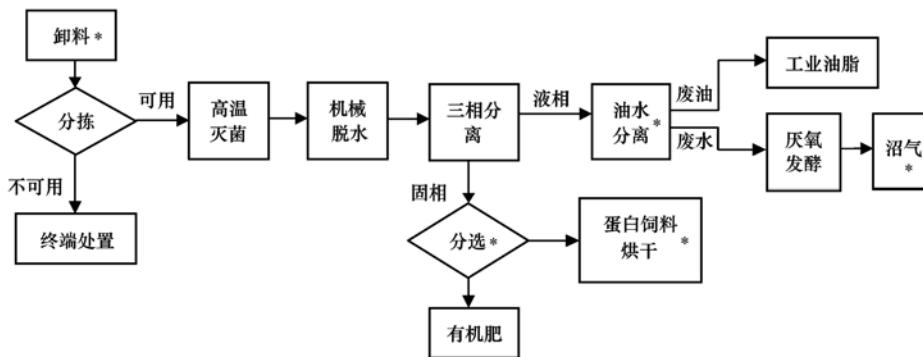
图2 宁波餐厨垃圾厂工艺流程示意
