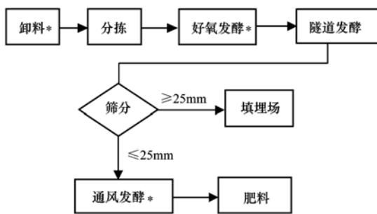
图3 北京餐厨垃圾厂工艺流程示意
