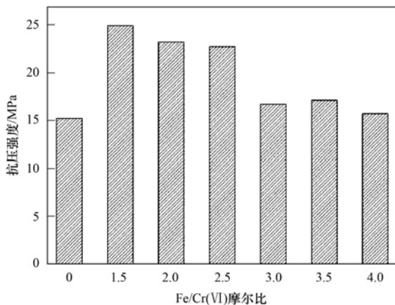
图 2 随着铁粉投量的增加固化体 28 d 抗压强度变化情况
