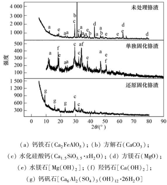
图 3 未处理铬渣、只经固化处理的铬渣和经还原固化处理的铬渣的 XRD 图
