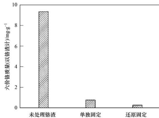
图6 碱消解法测定未处理铬渣、单独固定化样品及还原固定化(Fe/Cr(VI)摩尔比为3)样品中Cr(VI)含量
