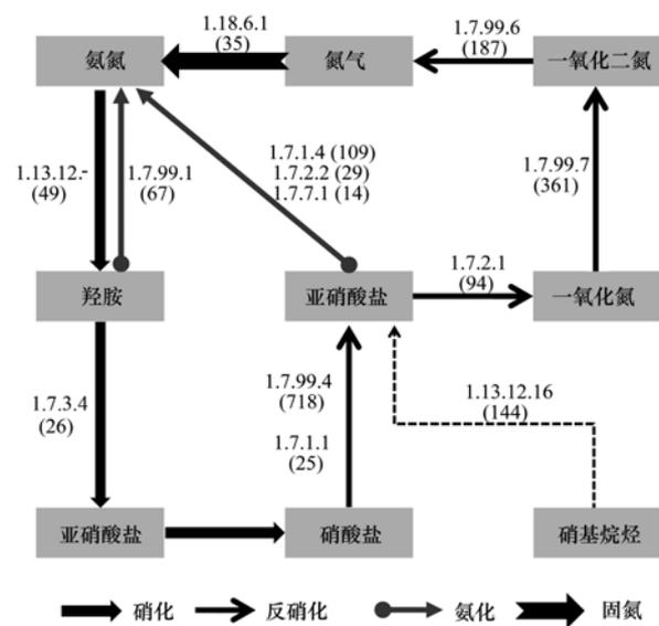
图 6 百乐克 (BIOLAK) 活性污泥氮循环(硝化、反硝化、氨化和固氮)中关键酶的数量
