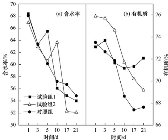
图2 污泥堆肥过程含水率、有机质变化
