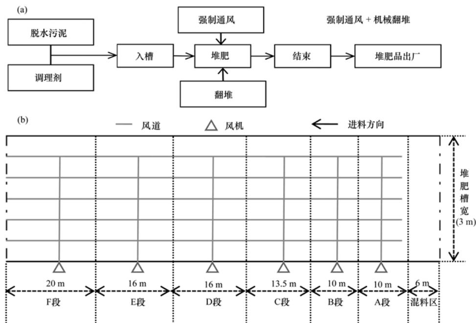
图1 污泥堆肥工艺流程及堆肥槽示意
