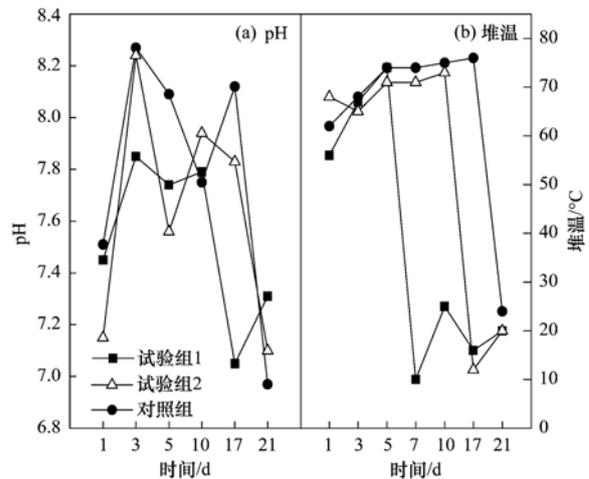
图3 污泥堆肥过程 pH 值和堆体温度变化
