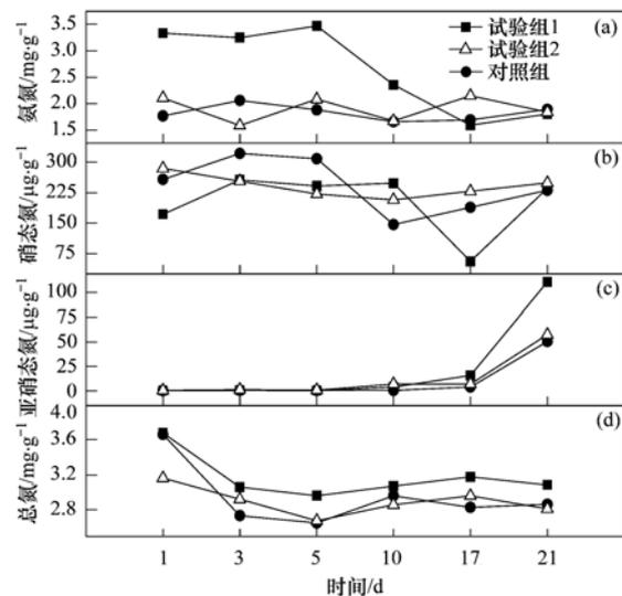
图4 污泥堆肥过程堆料氨氮、硝态氮、亚硝态氮、总氮的变化
