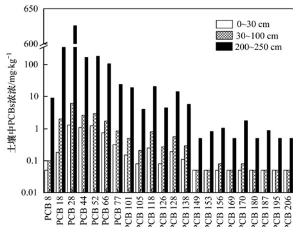
图 2 废旧电容器封存点不同深度土壤中 PCBs 单体浓度
