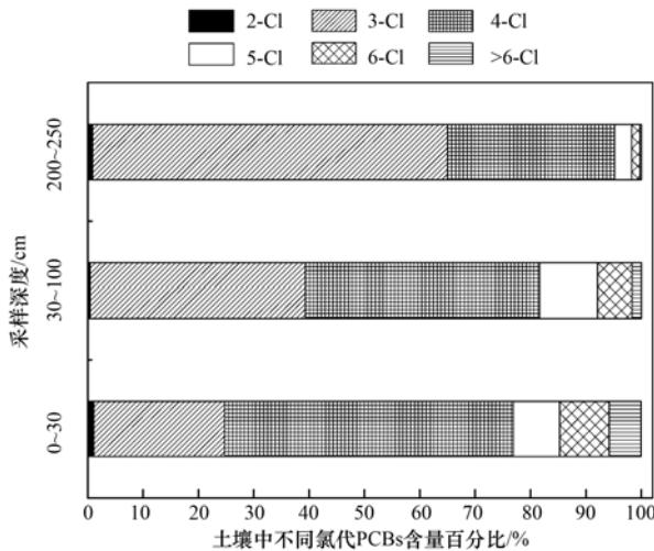
图 3 废旧电容器封存点不同深度土壤中氯代 PCBs 比例
