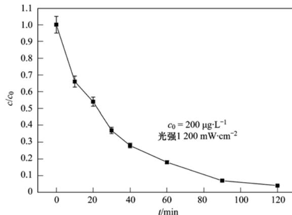
图 1 CBZ 在氙灯光源下的光降解曲线
