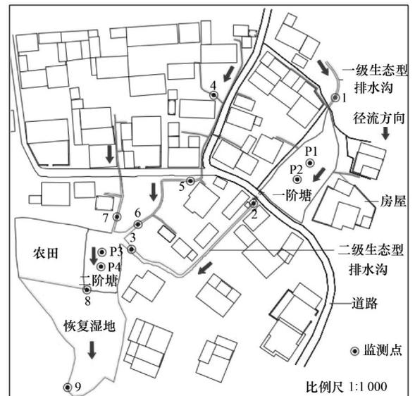
图2 牌坊陈村生态型排水系统构建及监测点示意
