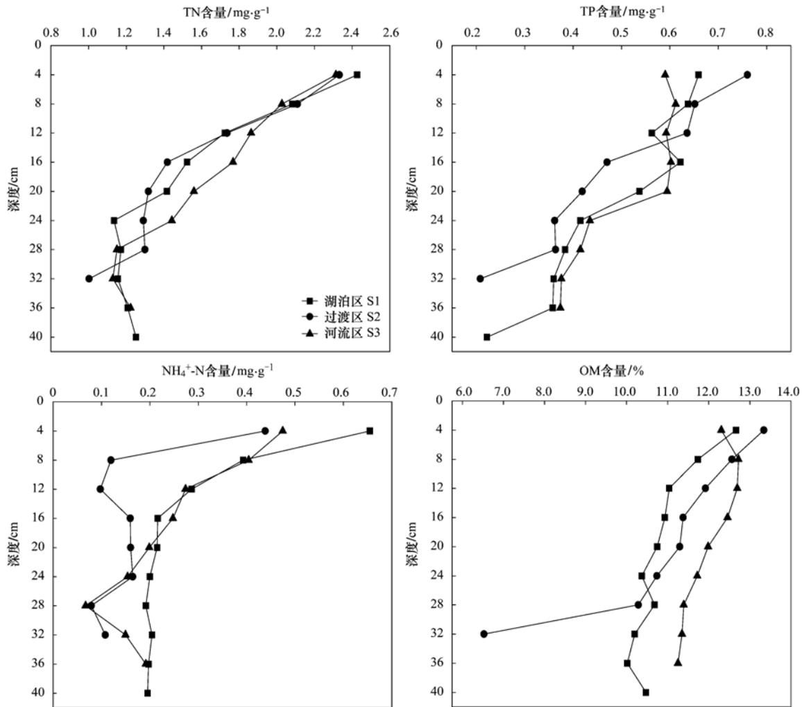
图 3 鹤地水库沉积物 TN、NH<sub>4</sub><sup>+</sup>-N、TP 及有机质含量的垂直剖面分布
