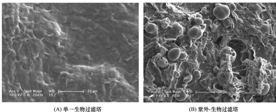
图 3 单一生物过滤塔和紫外-生物过滤塔中生物膜的扫描电镜图(第 260 d)
