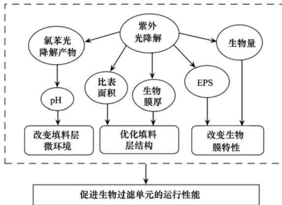
图5 紫外单元对生物过滤单元的影响途径
