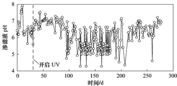
图 2 紫外-生物过滤联合工艺渗滤液 pH 随时间的变化
