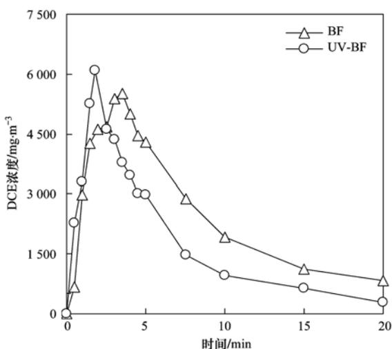
图 4 不同工艺中生物过滤塔的典型 MRTD 曲线(第 261 d)
