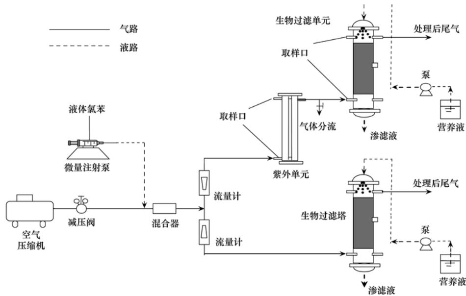
图 1 紫外-生物过滤联合工艺的实验装置示意
