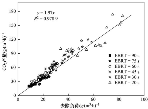
图4 CO<sub>2</sub> 产量随氯苯去除负荷的变化关系
