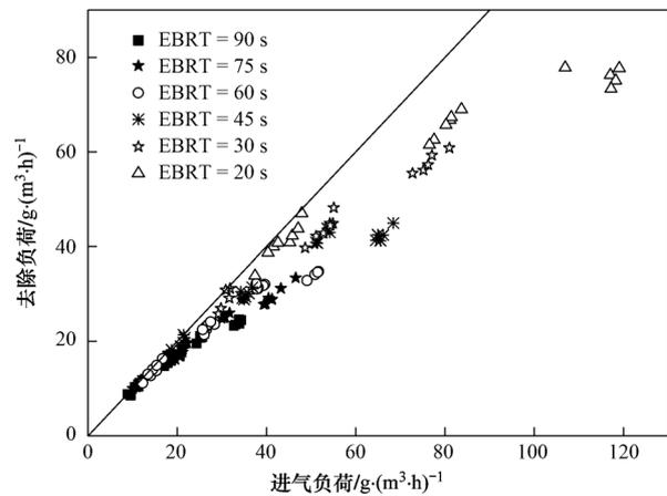
图 3 去除负荷随进气负荷的变化
