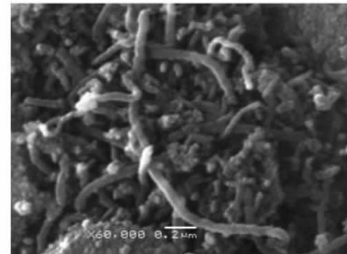
图 1 复合光催化剂扫描电镜照片
