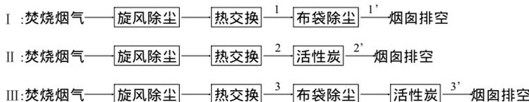
图 1 烟气净化系统流程图和采样点
