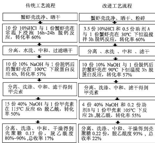
图 1 2 种制备工艺流程的比较
