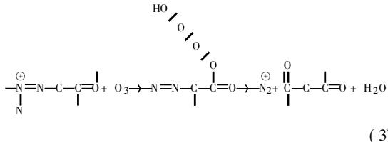
式(3)所示反应为动力学一级, 而且大多数人工合成的染料均可被  $\text{O}_3$  迅速降解, 降解产物主要为低级脂肪酸或  $\text{CO}_2$ , 这同样取决于染料性质、水的成分和作用条件。但经适当催化臭氧处理后, 废水中的染料基本可以被去除, 水质达到排放标准<sup>[14]</sup>。在染料废水中含有膏化剂将大大降低臭氧化效率, 如水中含有 200mg/L 爪耳胶使臭氧化速率降低 35%, 而 480mg/L 则降低了 58%<sup>[14]</sup>。这一问题是否可以通过某些催化过程得以解决, 尚未见报道。
