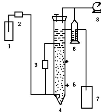
图1 AAFEB反应器装置和工艺流程
