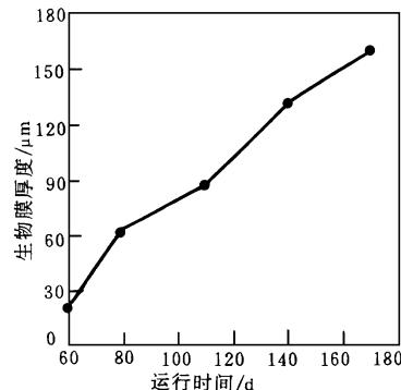
图 4 生物膜厚度的变化曲线
