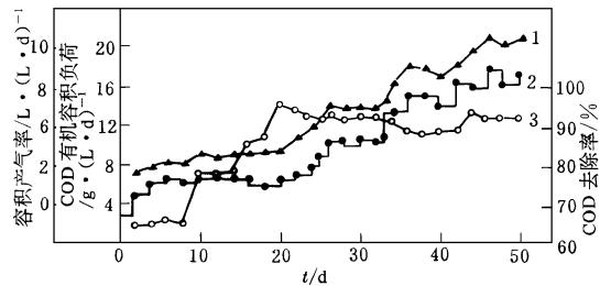
图 3 起动过程中容积产气率、容积 COD 有机负荷、COD 去除率的变化
