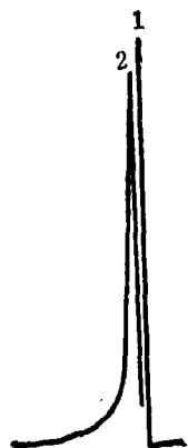
图 3 污水样品色谱图 浓度 94ppb, 进样体积 2 \mu l 1—CH 2 Cl 2 2——总有机磷
