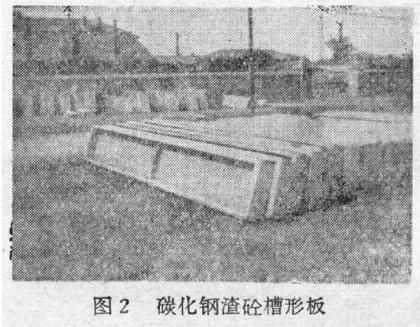
图 2 碳化钢渣砼槽形板
