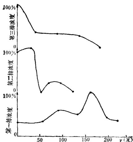
图8 稳定条件下,地面各排横风取样点浓度分布图
