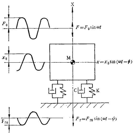
图1 积极减振模拟图
