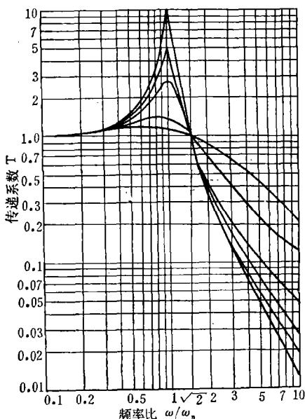
图 2 传递系数 ( $T$ ) 与频率比  $\left(\frac{\omega}{\omega_n}\right)$
